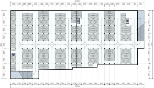
2# 停车库平面图 本层建筑面积 8600m 2 机动车停车位 400 个
